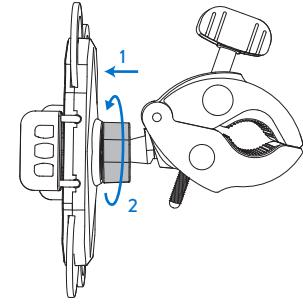
4. 調節ねじを緩めて自転車固定クリップをハンドルの幅に調整する。
