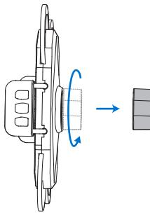
2. 固定ナットを自転車固定クリップの連結ボールに通す。(連結ボールは必ず口小さい側に向かう。)
