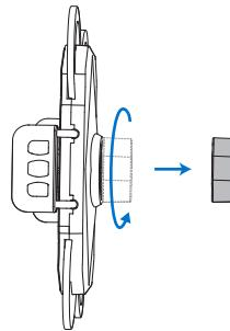
2. Setzen Sie die Befestigungsmutter auf die Verbindungskugel des Fahrradclips (Die Verbindungskugel muss zur Seite mit der kleineren Öffnung zeigen).
