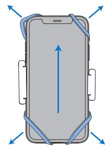
**Hinweis:** Dieses Produkt wird mit einem Ersatzgummiband geliefert. Wenn das Gummiband des Handyhalters nach längerem Gebrauch beschädigt ist, befestigen Sie den Ersatzgummiband an dem runden Loch auf der Rückseite des Handyhalters. Befolgen Sie dann die normalen Installationsschritte ist ok.
