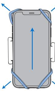
注意: 本製品に一つのシリコン結束バンド備品を贈呈するので、クリップのバンドが長期間使用によって破損する場合、図の通りに備品を携帯クリップ裏の円穴に固定してからホルダーの正常ステップに取り付けたら普通に使用できる。
