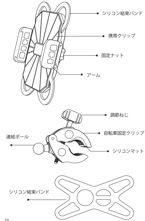
5. 自転車固定クリップをハンドルに固定して調節ねじを締めてホルダーを固定する。
