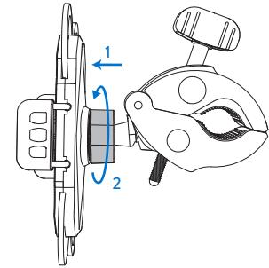
4. Schrauben Sie die Einstellschraube ein bisschen los und stellen Sie die Öffnung des Fahrradclips auf die Breite des Lenkers ein.
