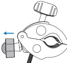
3. 携帯クリップ裏の円穴と合わせて連結ボールを力入れて中に入れて、固定ナットをしめる。
